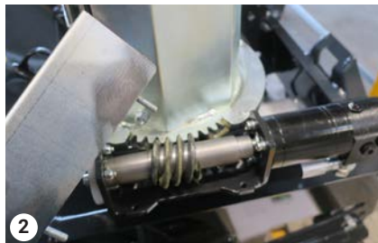
Отстранете капака и гресирайте червячната предавка
